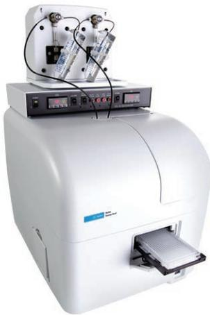
配备 CO<sub>2</sub>/O<sub>2</sub> 气体控制器和双加样器 Synergy Neo2
