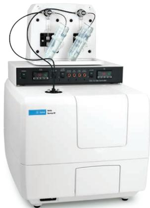
配备 CO<sub>2</sub>/O<sub>2</sub> 气体控制器和双加样器的 Agilent BioTek Synergy H1
